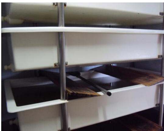
Figura 8 – Tanques de salmoura na Indústria de Laticínios Camozzato, Sananduva 2013.
