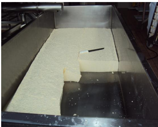
Figura 05 – Corte da massa em cubos grandes na Indústria de Laticínios Camozzato, Sananduva 2013.
